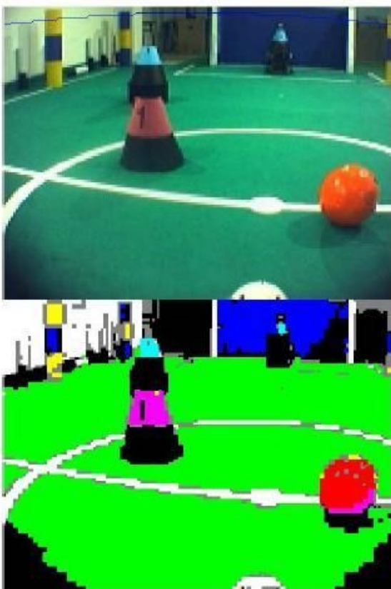
شکل 3- خطوط اسکن افقی در تصویر اصلی (دوربین روی سر)
